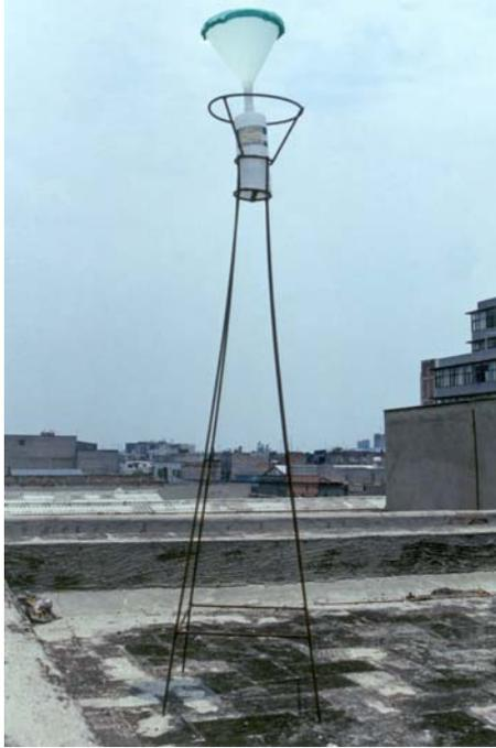
Figura 2. Colector semiautomático.
