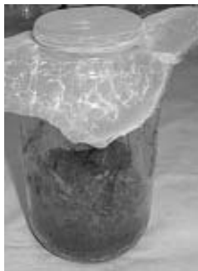
Figura 17.1. Frasco con tela para la prueba de toxicidad subcrónica con lombriz de tierra
