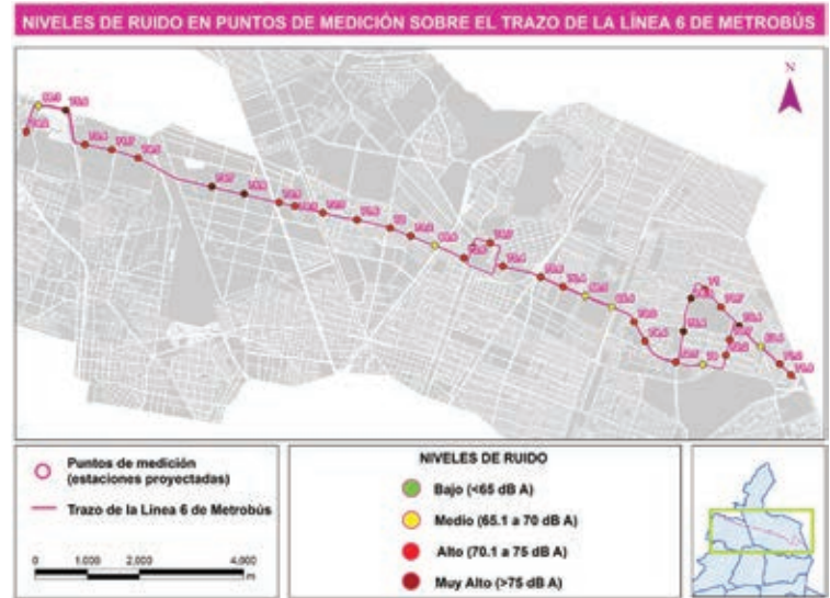
Figura 4. Niveles de ruido en puntos de medición sobre el trazo de la línea 6 de Metrobús
