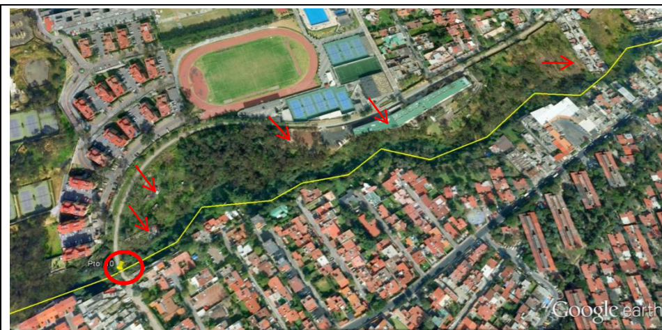
Figura 36. En la imagen satelital de Google Earth, se puede apreciar como las viviendas en la ladera derecha, al sur de la barranca (cauce=línea amarilla) se alinean al límite del talud y en la otra ladera hay algunas construcciones (flechas) que se muestran en las siguientes fotografías de abajo.
