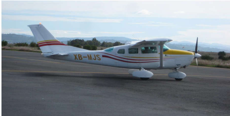
Figura 7. Aeronave Cessna Modelo 206 (monomotor turbo) utilizada para el levantamiento LIDAR (Ligth Detection and Ranging), especificado en la Licitación LA-909024988-N2-2014.
