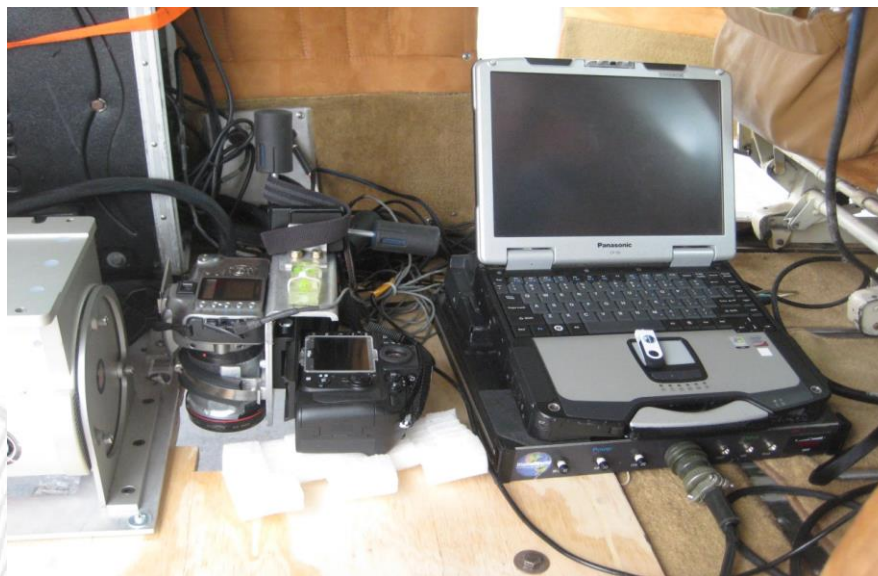
Figura 9. Montaje tipo de la consola de operación y control y cámaras digitales utilizadas para el levantamiento LIDAR (Ligth Detection and Ranging), especificado en la Licitación LA-909024988-N2-2014.
