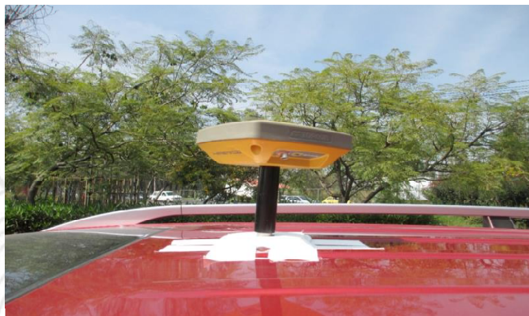
Figura 45. Vehículo adaptado con receptor GPS para el levantamiento cinemático realizado por la brigada terrestre del LIDAR de la Licitación LA-909024988-N2-2014.
