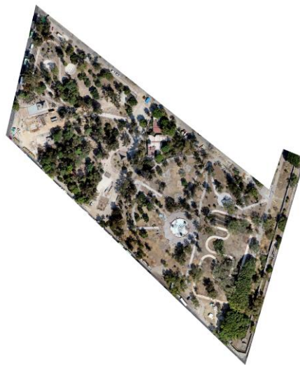
Imagen 4. Imagen obtenida por fotogrametría, a partir de las fotografías aéreas tomadas con el dron.
