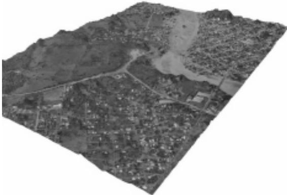
Composición de ortofoto digital con un modelo digital del terreno obtenido con lidar
