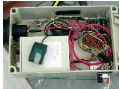
Equipo DOAS, circuitos electrónicos
