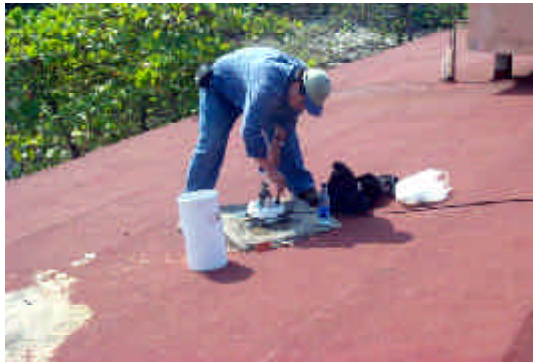
Mantenimiento y verificación de pluviómetros
