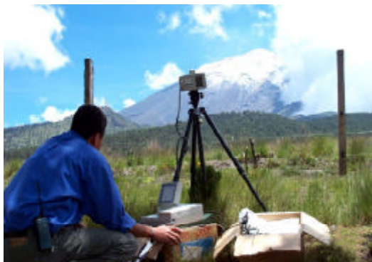
Medición de deformaciones en el volcán Popocatepetl
